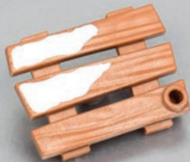
Das uneben gespritzte Bauteil wird im Doppel-druck bedruckt, um die Vertiefungen komplett mit Farbe auszufüllen.
