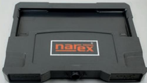
Der Kofferdeckel mit einer **unebenen Oberflächenstruktur** wird in zwei Druckdurchgängen mit dem zweifarbigen Kundenlogo versehen.
